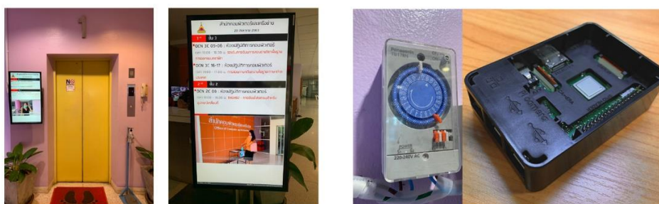
รูปที่ 1 จอประชาสัมพันธ์ที่มีการติดตั้งในอาคาร และ Timer ควบคุมเวลาเปิด-ปิดจอ และ Raspberry Pi ที่ควบคุมการแสดงผล
